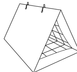
Ловушка из влагозащитного картона, ламинированного с двух сторон, с нанесенным на внутренние поверхности энтомологическим kleем, в комплекте с феромонным диспенсером.
